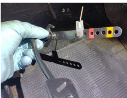
Exemple de la différence d'installation de la fixation de câble d'accélérateur sur une pédale à grand débattement : Trait jaune, pour carburateur 32 avec renvoi d'origine sur caché culbuteur R5 GTL / Trait rouge, origine 28IF
