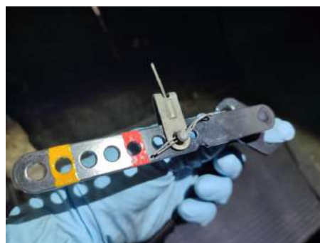
Exemple de la différence d'installation de la fixation de câble d'accélérateur sur une pédale à grand débattement : Trait jaune, pour carburateur 32 avec renvoi d'origine sur caché culbuteur R5 GTL / Trait rouge, origine 28IF
