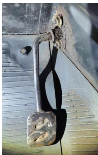
La pédale est retenue par deux écrous M6, une clé de 10 permettra son démontage en peu de temps
